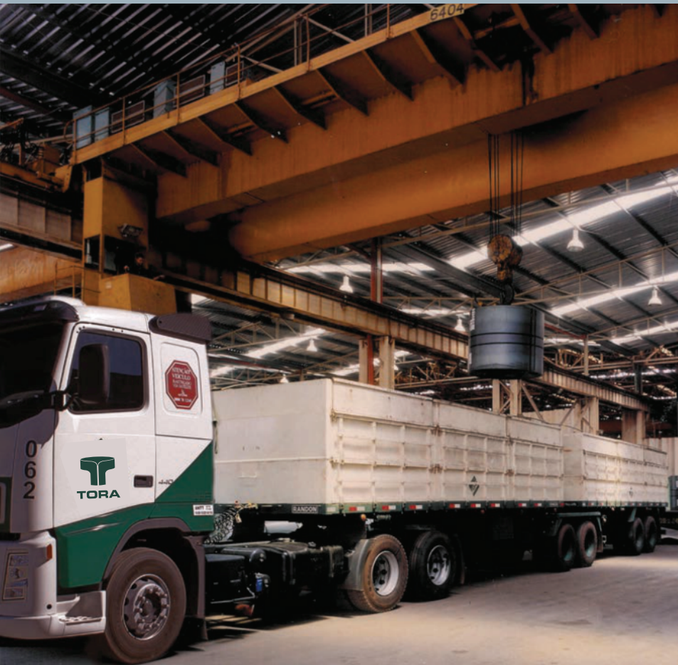
Carregamento de bobina através da ponte rolante.
